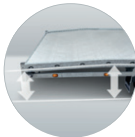
Abgesenkter Ladeboden am Heck
