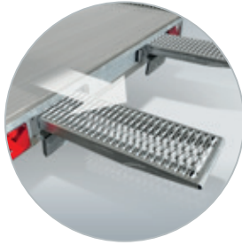
Stahl Auffahrampen von 250 cm in Kassette
