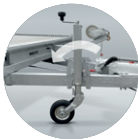
Zubehör: Klappbares Stützrad ermöglicht Weiterfahrt
